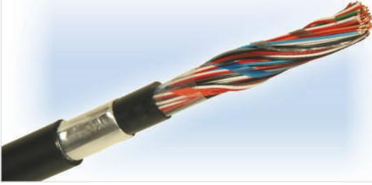
Esas olarak abone hatları için imal edilen bu kablolar sinyal ve koruma devreleri kabloları olarak yeraltı tesislerinde, devamlı su altında kalmayacak kanallar içinde kullanılır. 0.50 mm. çapında olan iletkenli kablolar kısa mesafe dağıtım şebekelerinde; 0.60 mm ve 0.90 mm çapında olan iletkenli kablolar uzun mesafeli dağıtım şebekelerinde kullanılır. Enerji kablosu olarak kullanılmazlar
