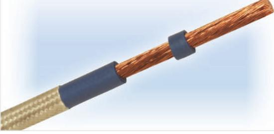
Silikon kauçuk yalıtımlı, cam elyaf iplik örgülü bu kablolar, tek damarlı kablolar yüksek ısılara ve de düşük ısılara maruz kalan kuru yerlerde, aydınlatma elemanlarında, alet ve makinelerde, fırınlarda, ortam ısısının -60°C ve +180 °C olduğu yerlerde kullanılırlar.
