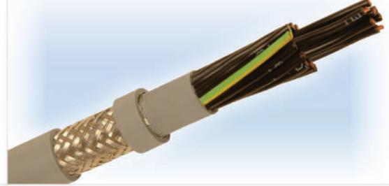
Bu ekranlanmış yağa ve aleve dayanıklı esnek kablolar proje mühendisliğinin gerektirdiği enstrümantasyonda, kontrol cihaz ve makinelerinde, taşıma cihazlarında, üretim hatlarında, serbest hareket gereken yerlerde, kuru, nemli, ıslak ve yağlı ortamlarda kullanılır. İç kılıf üzerindeki ince kalaylı bakırdan örülmüş ekran 30MHz'de harici yüksek frekanstaki gürültelere ve sinyallere karşı koruma yaparak maksimum transfer empedansı 250 Ω/km olmasını sağlamaktadır.
